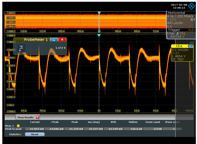
R&S®RT-ZPR Power Rail Probe와 Probe 자체에 통합된 고정밀 R&S®ProbeMeter를 사용하여 DDR 메모리의 초기화 중 DC 레벨과 전력공급 부하 응답을 정확하게 검증하십시오.
