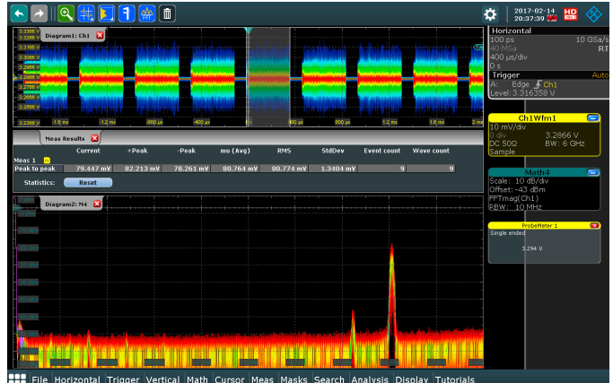
R&S®RT-ZPR Power Rail Probe의 높은 대역폭으로 고주파수 노이즈 성분을 캡처할 수 있습니다.
