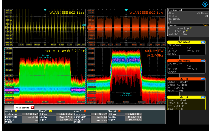
R&S®RTP의 WLAN IEEE 802.11n 및 11ac MIMO 신호 다중 채널 주파수 분석
