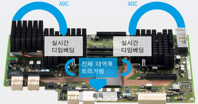
R&S®RTP 실시간 디임베딩 및 트리거 보드
