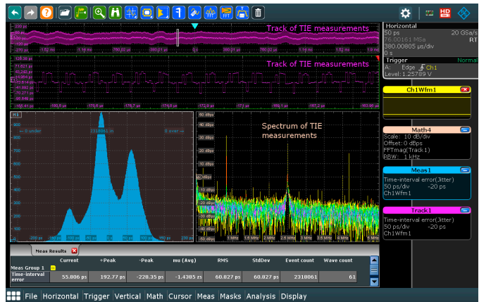
클럭 신호 내 주파수 간섭 탐지: TIE 지터 추적, 추적 곡선의 히스토그램 및 FFT 분석
